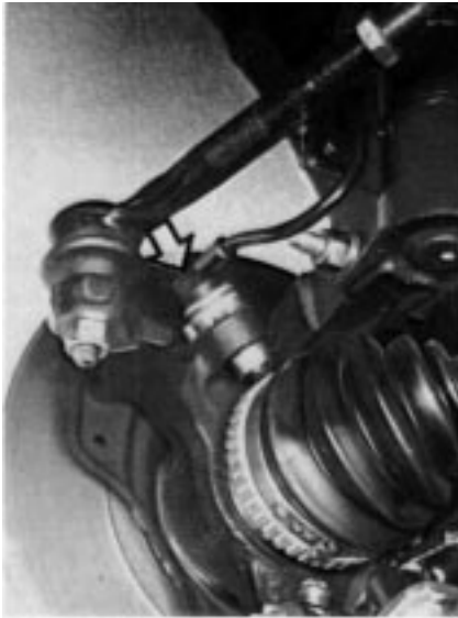
Umístění čidla otáček předního kola
