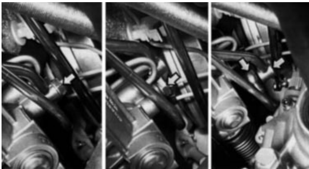
Demontáž a zpětná montáž přepadové trubky k nádržce a přívodní tlakové trubky k převodce řízení
