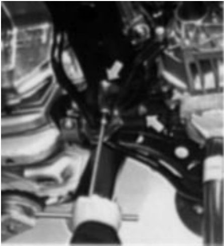
Demontáž a montáž zadního závěsu motoru
