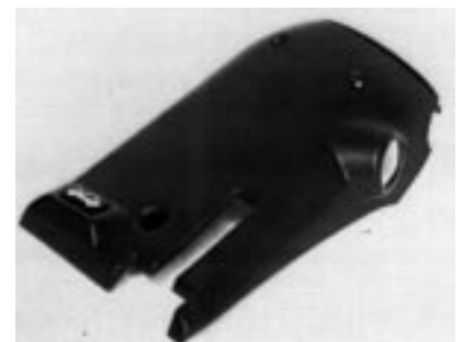
Demontáž a montáž spodního krytu horní části sloupku řízení
