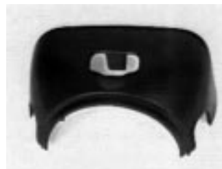
Demontáž a montáž horního krytu horní části sloupku řízení
