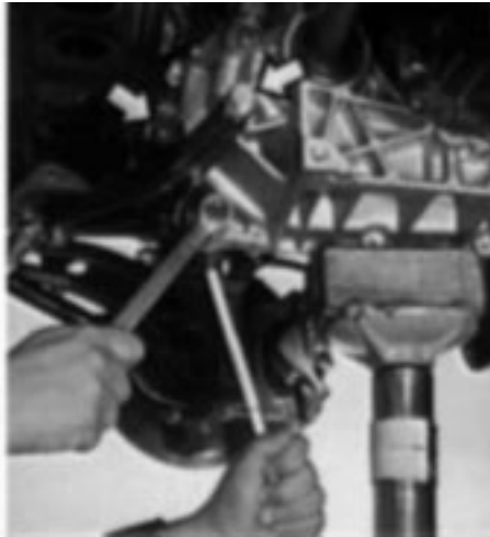
Demontáž a montáž zadního závěsu motoru
